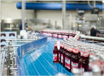
Abfüllanlage für Einwegflaschen
